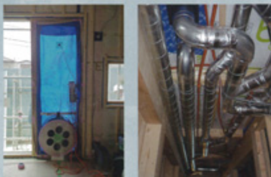
気密測定の様子。米國版パッシブハウスの認定申請のため、日本式・米式での2種類の気密測定を実施した。結果は基準（0.2）を大きく下回った
